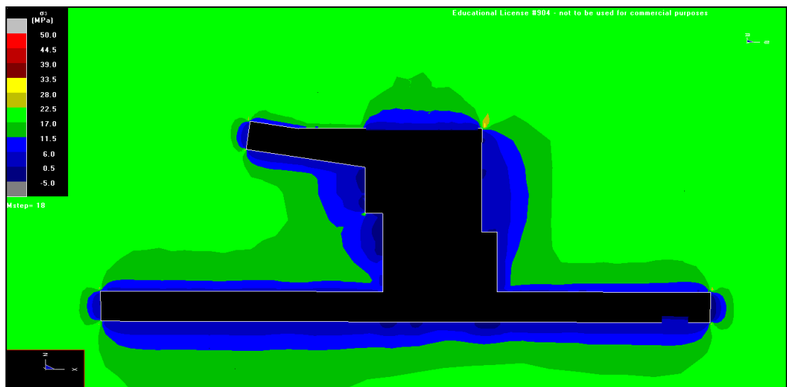
Figura C.7: Distribución del Esfuerzo Principal Menor Perfil EW Etapa N°18 Zona Norte Fuente: Elaboración Propia, 2016.
