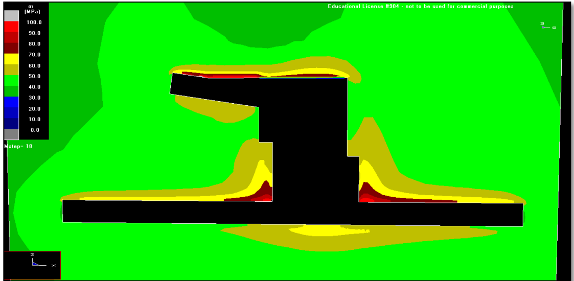
Figura C.18: Distribución del Esfuerzo Principal Mayor Perfil EW Etapa N°18 Zona Centro. Fuente: Elaboración Propia, 2016.
