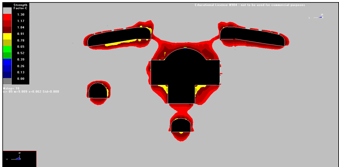
Figura C.13: Distribución de la Zona de Daño Perfil NS Etapa N°15 Zona Norte.
